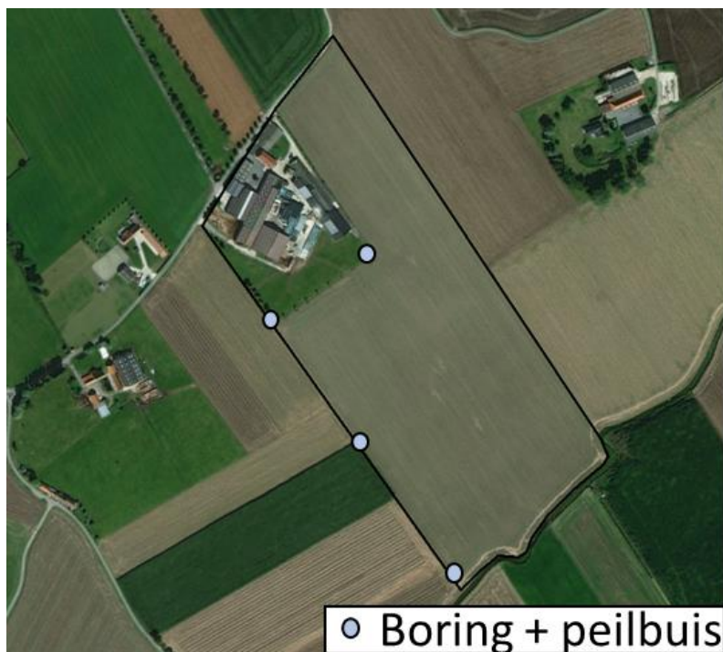
Figuur 4.19. Locaties van boringen en peilbuizen.
